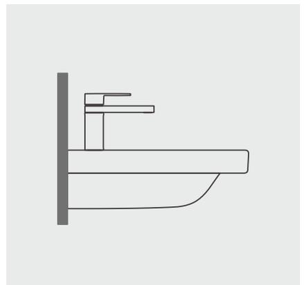
水流碰到洗面盆的位置——最好是在出水嘴前后——取决于高度、突出和喷射角度。
