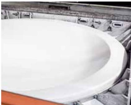
压克力板材被加热并真空吸入模具。一旦冷却, 磨制产品退出并精准打磨抛光。
